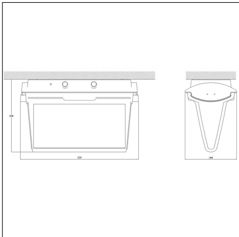
Frostsichere Sicherheits- und Rettungszeichenleuchte für den Einsatz bis  $-20^{\circ}\text{C}$ , als Einzelbatterie-Notleuchte mit AUTOTEST-Funktion, Signalisierung über 3x farbige Status-LED, inklusive Prüftaster, gemäß DIN EN 60598-1, DIN EN 60598-2-22, DIN EN 62034 und DIN EN 1838 für Anlagen gemäß DIN VDE 0108, zum separaten Betrieb.
